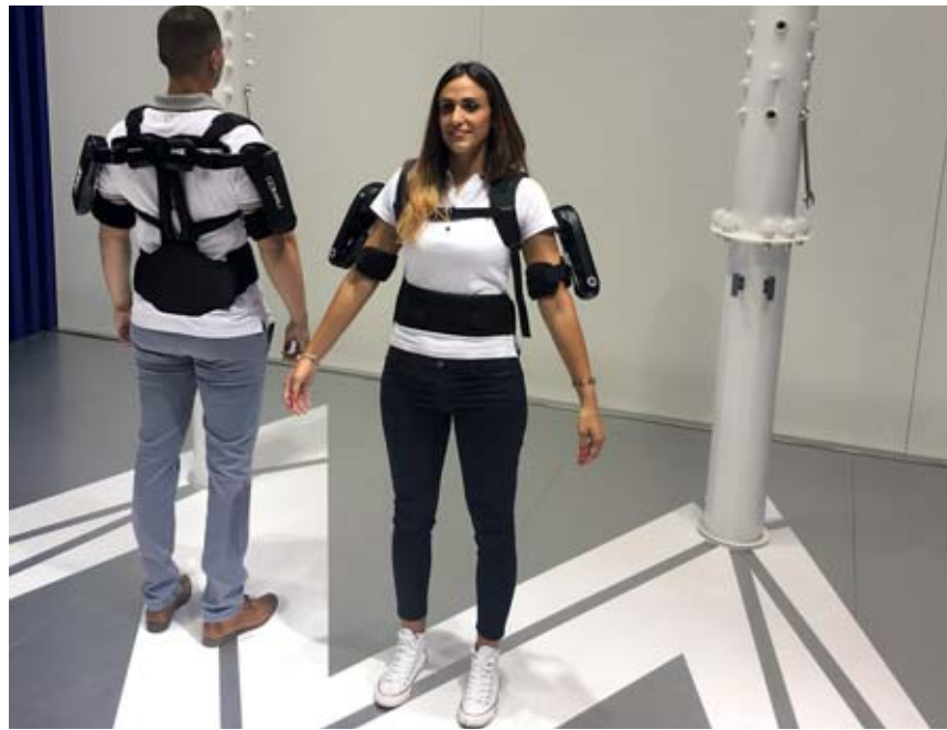
Mit dem Exoskelett können Werker ihre Aufgaben mit weit weniger Kraftaufwand ausüben.
