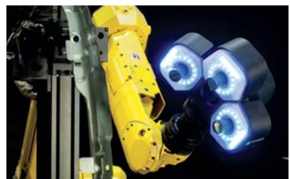
Hexagon Manufacturing Intelligence stellt mit dem Qflash A ein kompaktes automatisches Messsystem vor. Bild: Hexagon
