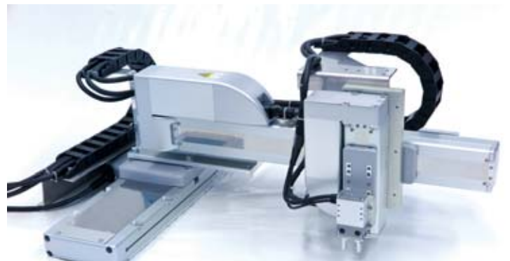
Das innovative Roboterhandgelenk eignet sich für kartesische Roboter wie diesen hier. Bilder: IAI Industrieroboter
