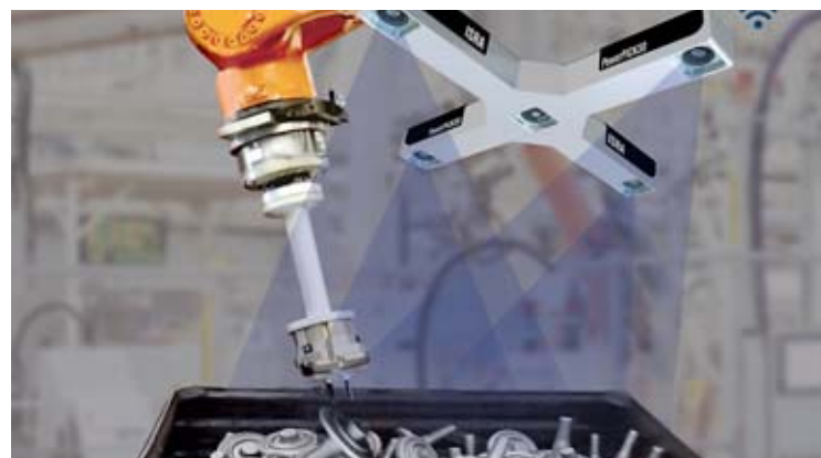
Die Bin-Picking-Generation PowerPick3D liefert durch die Quad-Camera-Technologie kürzeste Taktzeiten bei jedem Bauteil- und Containertyp. Bild: Isra Vision
