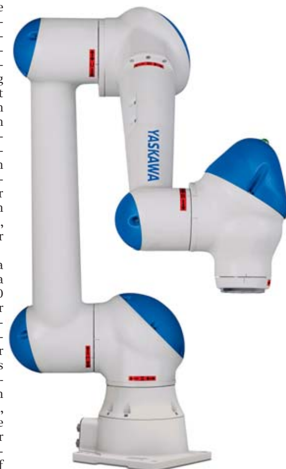
Der kollaborative Roboter Motoman HC10 kann jetzt auch mit einem ‚Smartpendant‘ oder mit ‚Direct Teaching‘ programmiert werden. Bild: Yaskawa
