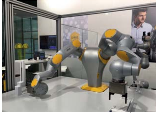
Pilz Die Firma aus Ostfildern sieht sich selbst nicht als Roboterhersteller, sondern als Anbieter von Modulen für die Servicerobotik. Dass man aus diesen Modulen einen Zweiarm-Roboter fertigen kann, zeigt das Exponat am Messestand.
