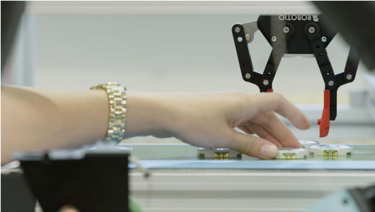
*beyerdynamic2:* Für die Membranbeschichtung platziert ein Arbeiter einen geschweißten Kopfhörerlautsprecher auf einer vordefinierten Fläche, sodass die in der Roboterapplikation integrierte Kamera so das Werkstück erkennt und der Cobot es aufnehmen kann.
