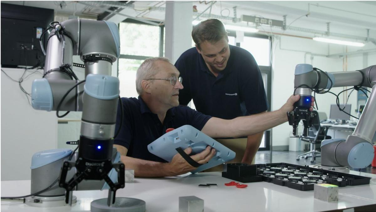
*Beyerdynamic5*: Peter Härtel und Jörg Lang programmieren die Roboter bei Beyerdynamic im sogenannten „Teach Modus“. Dank diesem kann jeder Anwender den Roboterarm greifen und ihm neue Aufgaben beibringen, indem er ihn per Hand von Wegpunkt zu Wegpunkt führt.
