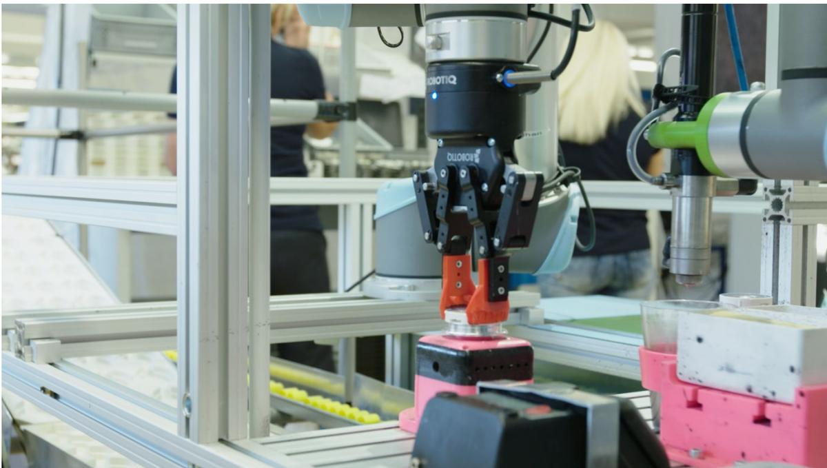
*beyerdynamic3:* Mittels eines 2-Finger Greifers von Robotiq nimmt der UR-Roboter den Lautsprecher auf und setzt ihn zur Weiterverarbeitung auf einen Drehmotor.
