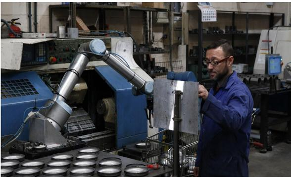
À la fin de la conception de la nouvelle cellule robotique, l'application pouvait être intégrée dans les usines de Portas. « Nous avons programmé le robot avec les toutes dernières machines en seulement quelques jours », a affirmé Enric Vila. « L'ancienne machine nécessitait un délai légèrement supérieur, mais tout était opérationnel en une semaine. »
